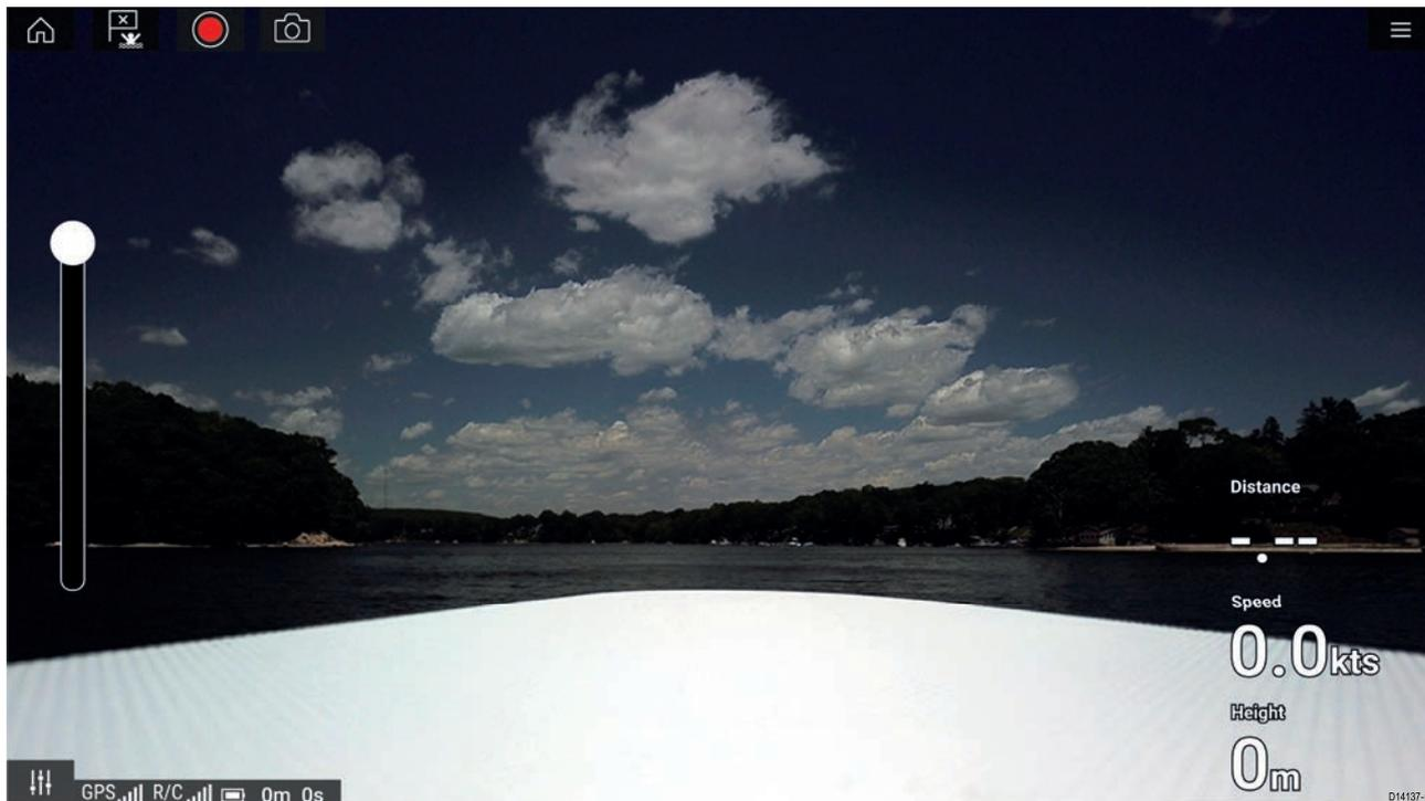
Una volta che il drone è configurato correttamente e collegato all'MFD e l'app UAV dell'MFD è registrata con successo, viene visualizzato il feed video del drone e l'app è pronta per essere usata come controller ausiliario del drone.
